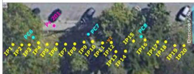
Fig. 3 Punti di iniezione e flusso della falda
