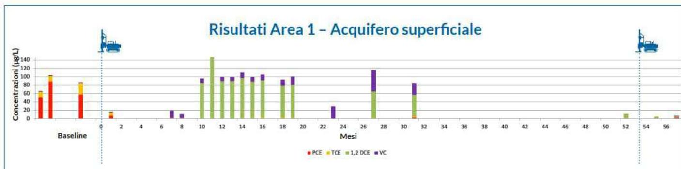
Fig. 8: Concentrazioni medie di clorurati nell'Area 1 nel tempo, pre e post-iniezione (trattamento dell'acquifero superficiale). L'area ha ricevuto un'applicazione ISCR aggiuntiva per gestire la contaminazione in ingresso da monte
