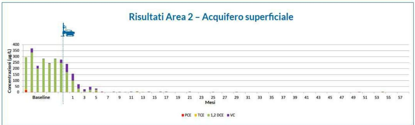
Fig. 9: Concentrazioni medie di clorurati nell'Area 2 nel tempo, pre e post-iniezione (trattamento dell'acquifero superficiale)
