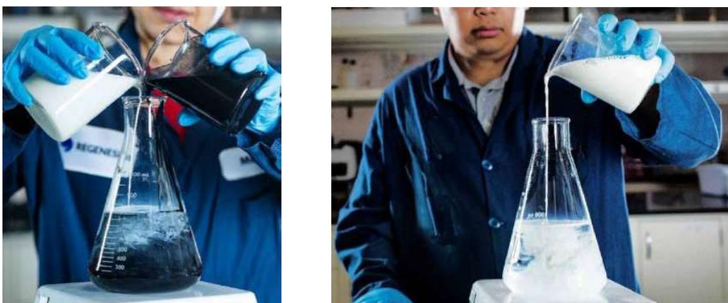
**Figura 6-3 – Miscelazione dei prodotti PlumeStop, Aquifix e S-MicroZVI**
