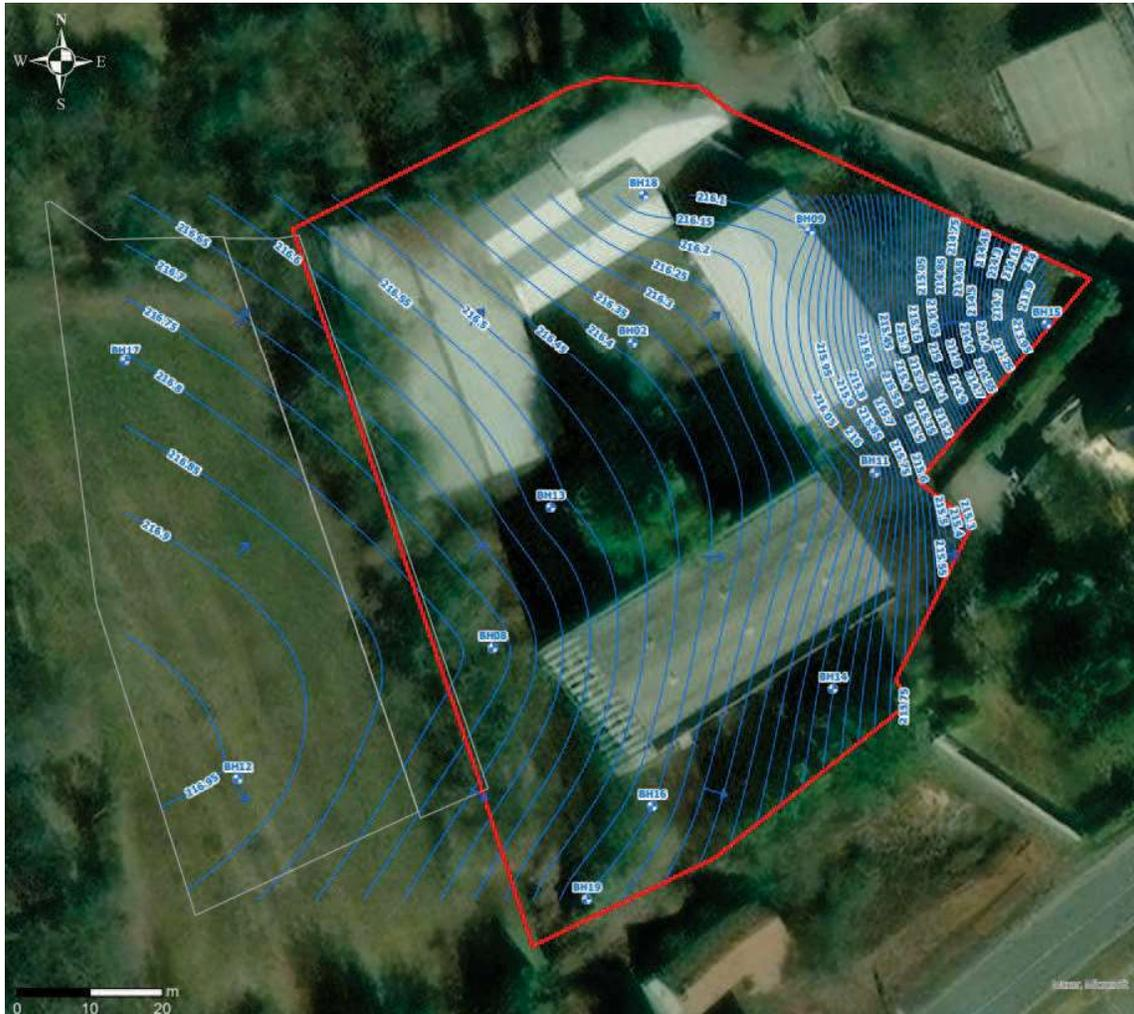
**Figura 1:** ricostruzione piezometrica
