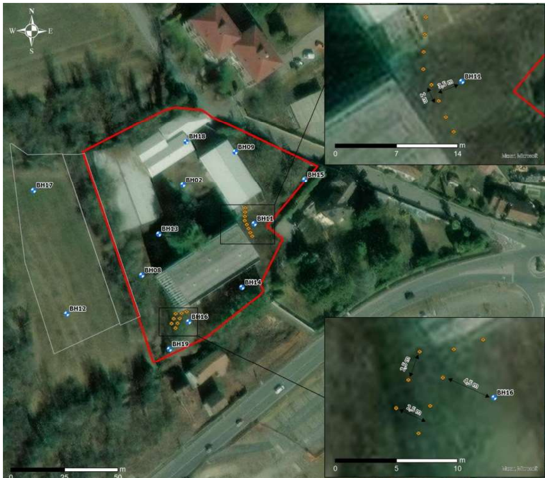
Figura 2: configurazione delle aree test pilota e punti di iniezione
