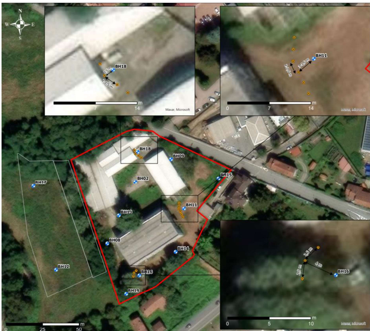
Figura 1: punti di iniezione del test pilota Fase 1 POB.
