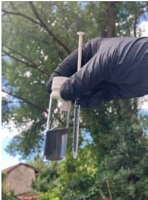
Foto 19: Verifica della presenza di prodotto ingegnerizzato nel piezometro di controllo (BH16)
