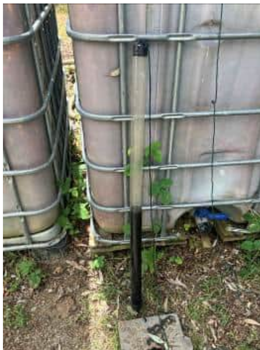
Foto 20: Verifica della presenza di prodotto ingegnerizzato nel piezometro di controllo (BH16)
